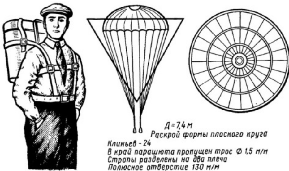
Эскиз ранцевого парашюта Г. Котельникова
